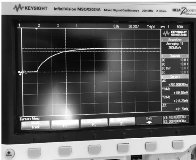
Рис. 4 Осциллограмма тока в катушке переключателя в режиме оптимального энергопотребления. R_{инд.} = 1 \text{ Ом}
